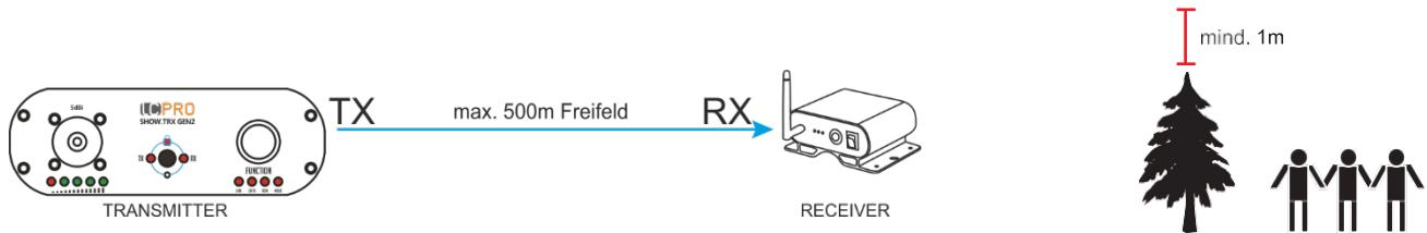
Die maximale Distanz zwischen Sender und Empfänger ist während des Betriebs abhängig von den Umgebungsbedingungen. Für eine optimale Datenübertragung sollte zwischen Sender und Empfänger Sichtverbindung bestehen und sie sollten sich mindestens 1 m über dem Publikum, Bäumen und anderen Hindernissen befinden. (Freifeld)
