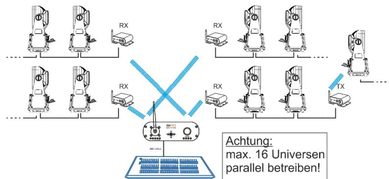
Die Abbildung oben zeigt den TX-Betrieb des Geräts. Das DMX-Signal wird am Show.TRX GEN2 eingespeist und von diesem per HF gesendet. Empfänger mit demselben Übertragungsprotokoll empfangen das HF-Signal und geben es als DMX-Signal aus. Durch Mehrpunktverbindungen können bis zu 16 DMX-Universen gleichzeitig genutzt werden. Die Empfänger reagieren nur auf den zugewiesenen Sender, ohne dass es zu Verzögerungen oder Störungen durch andere Systeme im Einsatzbereich kommt. (Latenz < 5ms)
