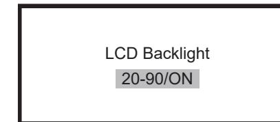
20-90: Wird innerhalb von 20 bis 90 Sekunden keine Taste gedrückt, schaltet sich das Display aus.
